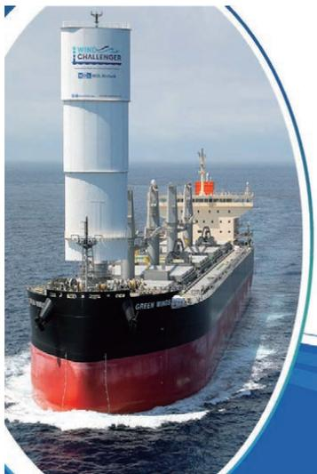
井は風の力を使って燃費削減を行っており、去年7月に竣工した船にはオモテ側に帆（ハードセール）を搭載しており、この帆で風の力を使って燃費を削減する、+燃料油の種類を変えていく、といった取り組みを行っています。
