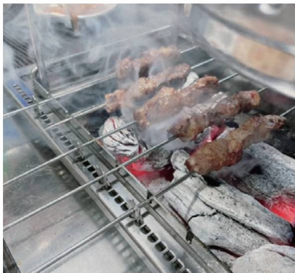
炭火の横にある装置が動くことにより、歯車が付いている金属製の串を回転させます
